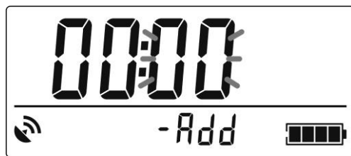
Рисунок 2.32 – PKI дозиметра (підрежим програмування нового зміщення місцевого часу відносно GMT)
