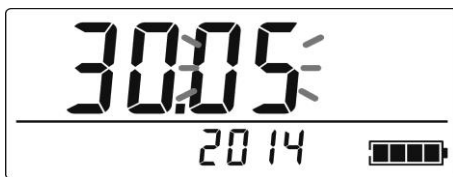
Рисунок 2.36 – РКІ дозиметра (підрежим корекції часу та дати – корекція числа та місяця)
