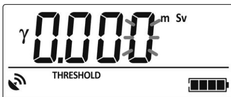
Рисунок 2.28 – РКІ дозиметра (підрежим програмування порогового рівня спрацьовування сигналізації)
