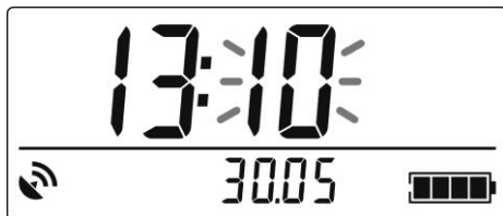
Рисунок 2.34 – РКІ дозиметра (підрежим корекції часу та дати – корекція годин та хвилин)
