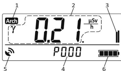
Рисунок 2.37 – РКІ дозиметра (режим перегляду результатів вимірювань, що записані в енергонезалежну пам'ять)
