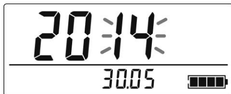
Рисунок 2.35 - РКІ дозиметра (підрежим корекції часу та дати – корекція року)
