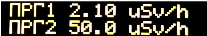
Рисунок 6 – Режим відображення встановлених порогових рівнів ПРГ1 та ПРГ2
