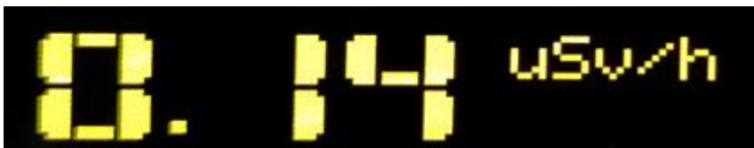
Рисунок 4 – Режим відображення індикації ПАЕД при під'єднаному блоку детектування
