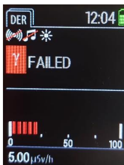
Рисунок 31 – Відображення помилки детектора виносного блока детектування
