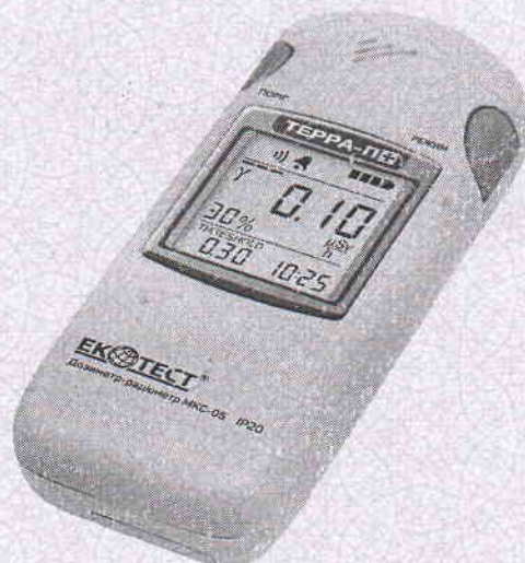
Дозиметр-радіометр МКС-05 «ТЕРРА-П+»
