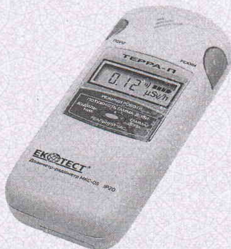
Дозиметр-радіометр МКС-05 «ТЕРРА-П»
