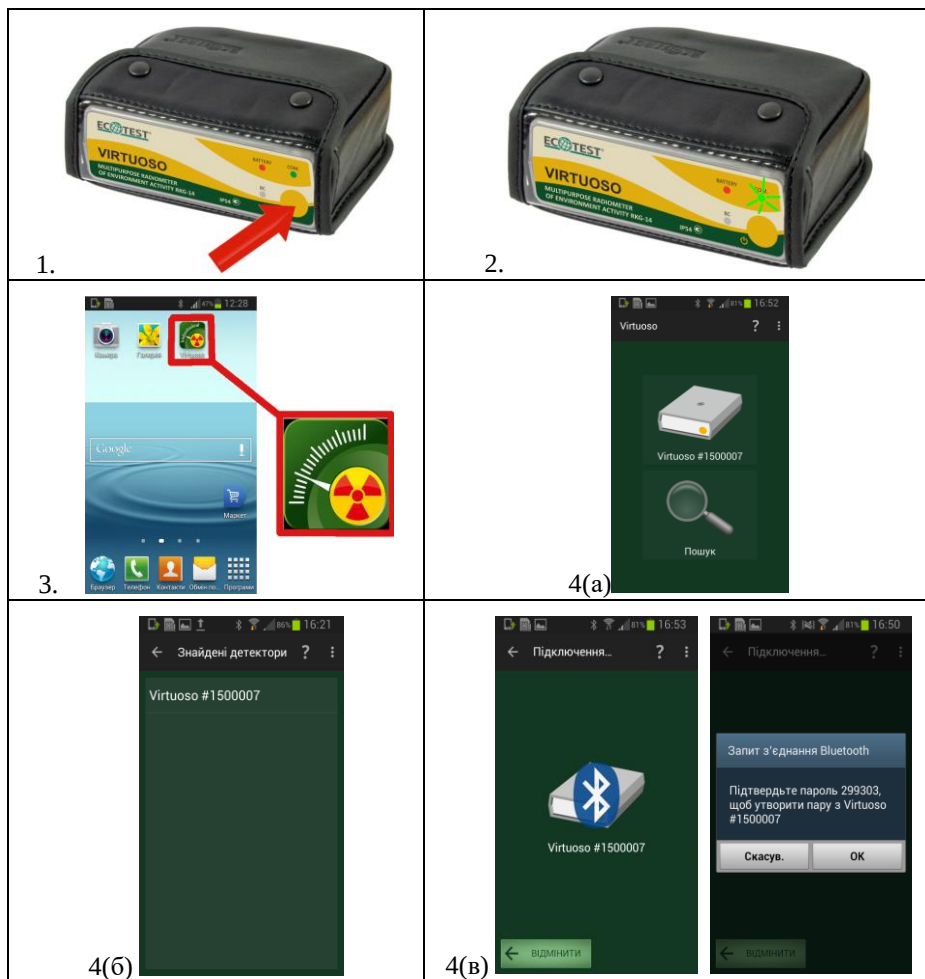
Рисунок 2.2 - Під'єднання Android-пристрою до детектора
