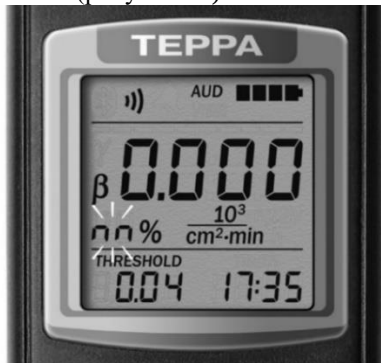
Рисунок 17 – РКІ дозиметра (перезапуск вимірювання)
