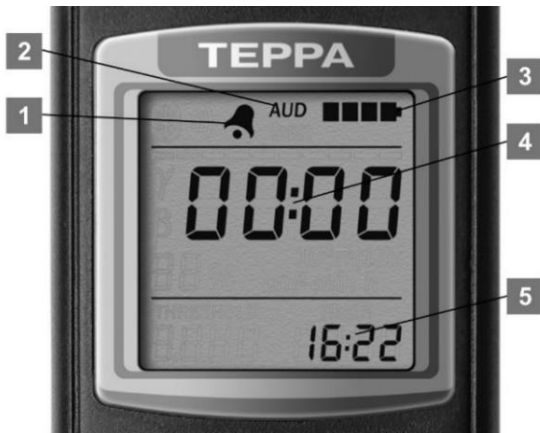
Рисунок 25 – РКІ дозиметра (режим будильника)
