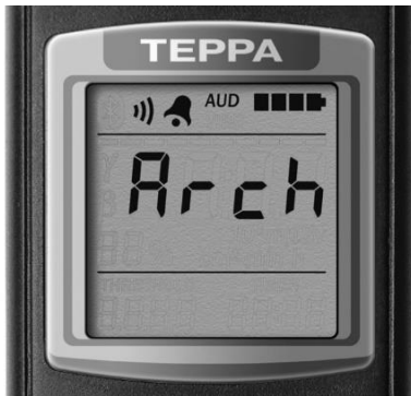
Рисунок 16 – РКІ дозиметра (початок підрежиму збереження результату вимірювання в енергонезалежній пам'яті)
