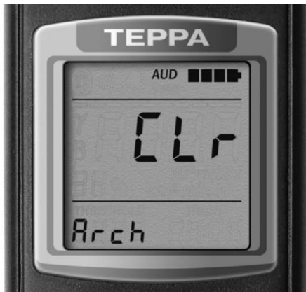
Рисунок 31 – РКІ дозиметра (підрежим стирання результатів вимірювань, що збережені в енергонезалежній пам'яті)
