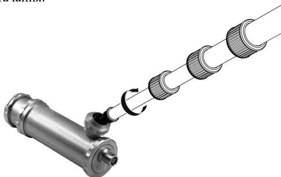
Рисунок 2.8 – Закріплення штанги телескопічної до БДКС-01
