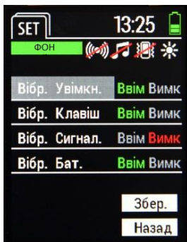
Рисунок 11 – Налаштування вібраційних сигналів
