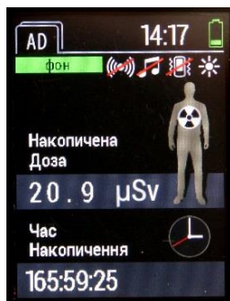
Рисунок 7 - Режим вимірювання АЕД
