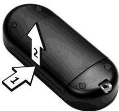
Рисунок 3 – Вказівка щодо знімання задньої накривки
