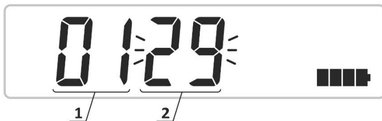
Рисунок 11 – РКІ дозиметра (перегляд та встановлення часу усереднення результатів вимірювань для точного режиму, а також перегляд статистичної похибки результату вимірювання)
