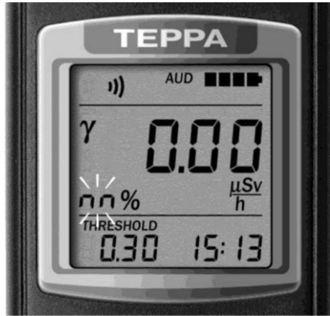
Рисунок 6 – PKI дозиметра (перезапуск вимірювання)
