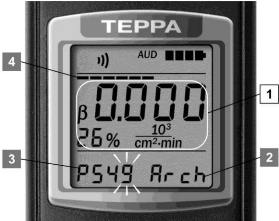
Рисунок 20 – PKI дозиметра
