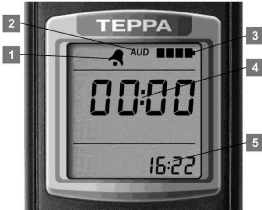
Рисунок 25 – РКИ дозиметра
