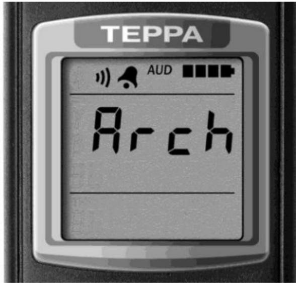
Рисунок 5 – РКІ дозиметра (початок підрежиму збереження результату вимірювання в енергонезалежній пам'яті)
