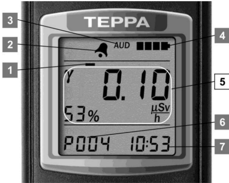
Рисунок 30 – PKI дозиметра
