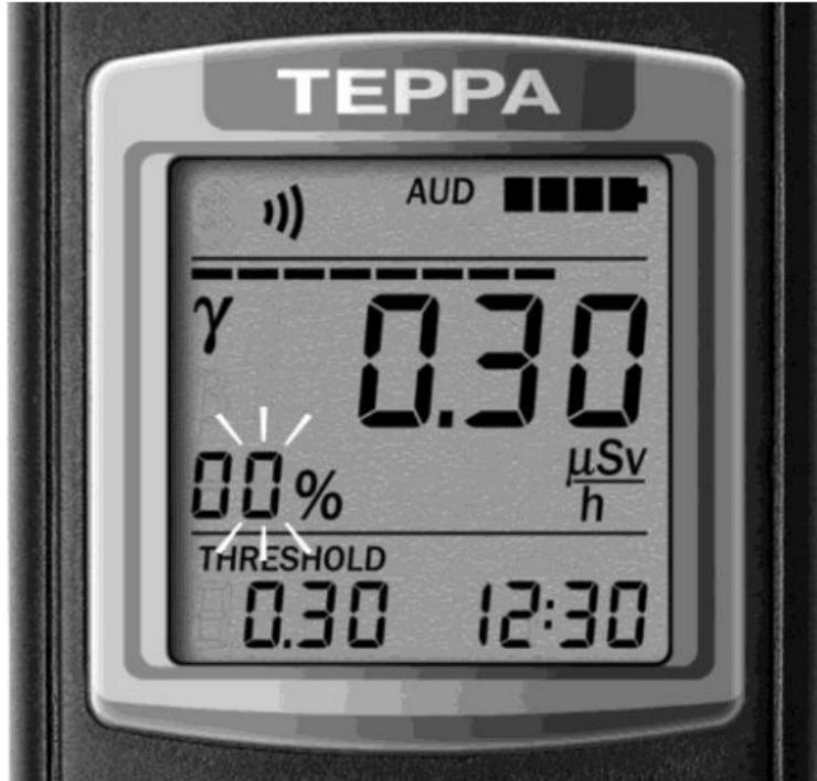
Рисунок 8 – РКІ дозиметра
