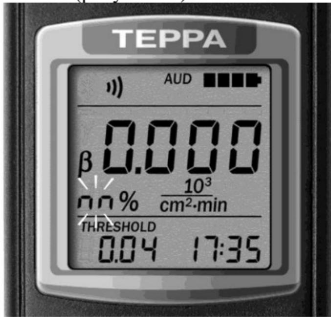
Рисунок 17 – PKI дозиметра (перезапуск вимірювання)
