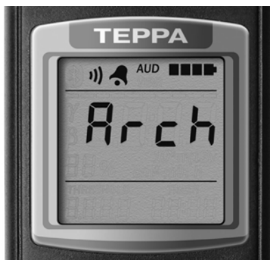
Рисунок 8 – ЖКИ дозиметра (начало подрежима сохранения результата измерения в энергонезависимой памяти)
